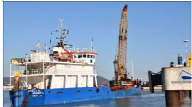
Motonave Angelo B Impegnata nelle attività di dragaggio a ciglio banchina
