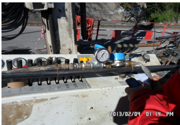
Figura 3: Prova Lugeon SG03
