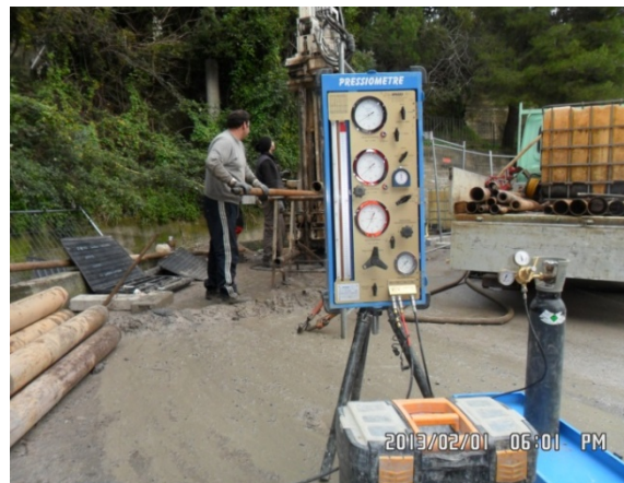
Figura 5: Prova pressiométrica SG3bis
