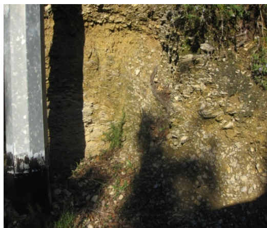
Figura 3: Calcarei marnosi completamente cataclazizzati (binario destro della DGPV Poseidon)
